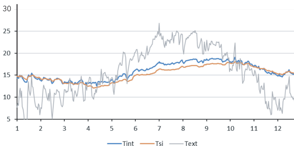
Figura 8. Resultados de la tendencia de la temperatura media diaria durante el año; aire interior, el aire exterior y la superficie interior. Elaboración propia con el uso de Design Builder.
