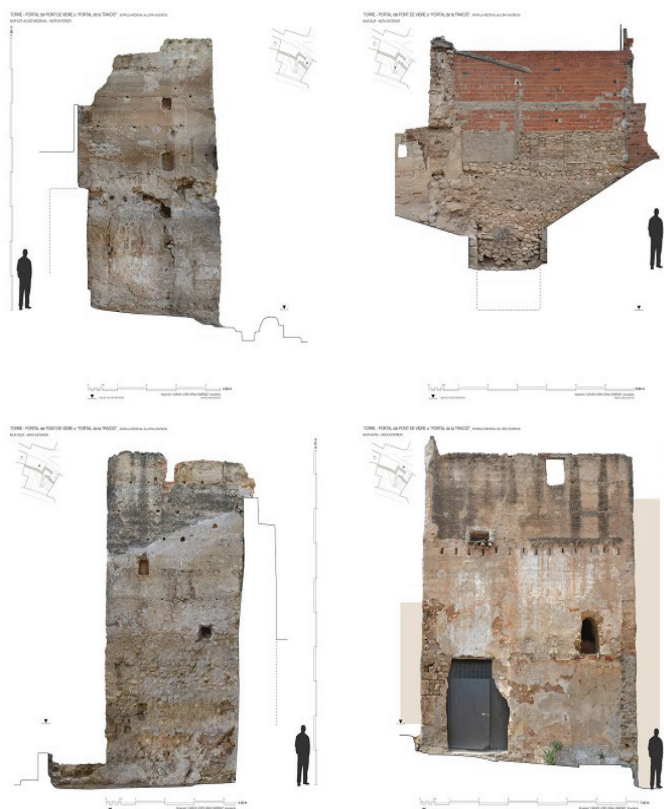
Figura 8. Levantamientos fotogramétricos de las fachadas este, sur, oeste y norte, respectivamente, antes de la intervención de 2020-2021 (composición a partir de TORNER, IBAÑEZ, VIDAL, 2018, fotogrametrías d C.J. Grau, Archivo Ayuntamiento de Llíria)
