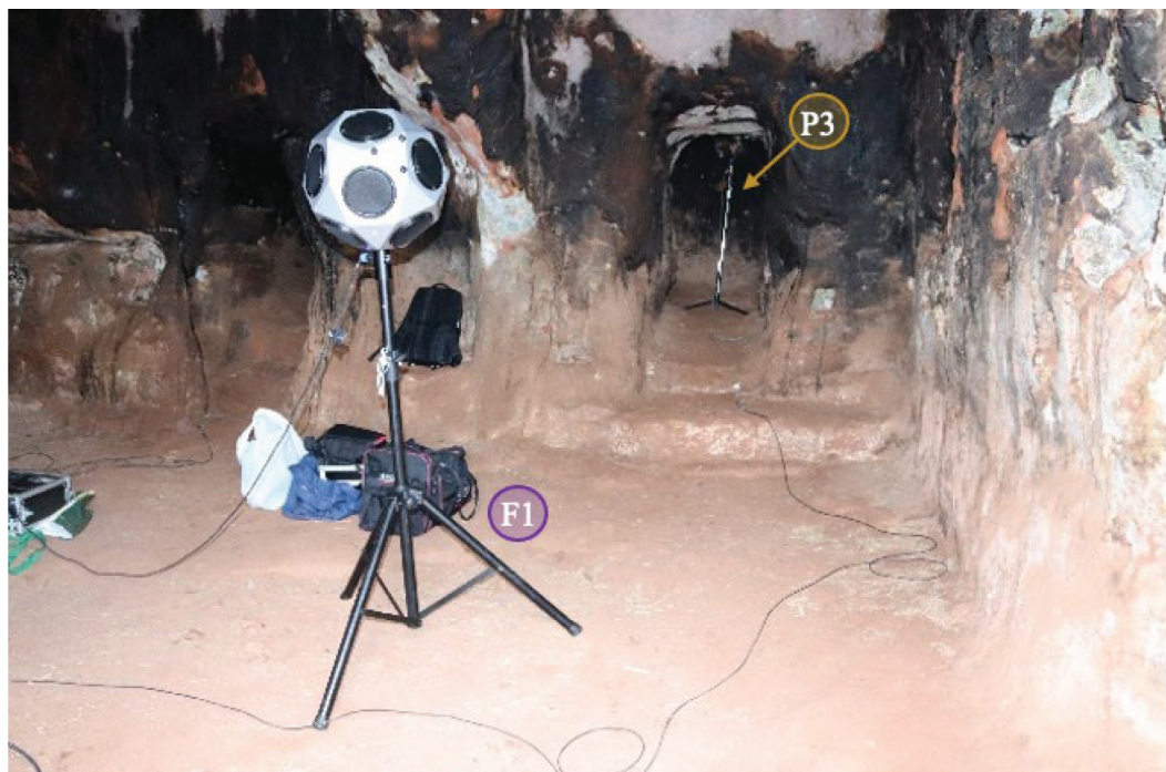
Figura 39. Relación posicional entre la fuente sonora F1 y posición de medida P3, en el interior de la cueva (A) del eremitorio rupestre de Valdecanales.
