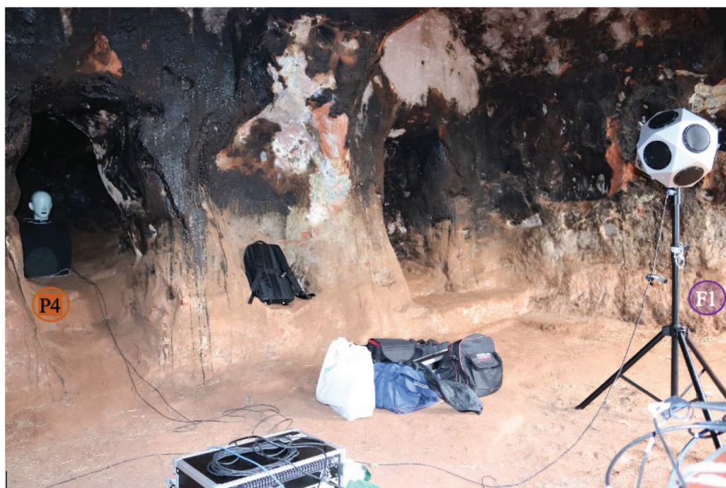
Figura 40. Relación posicional entre la fuente sonora F1 y posición de medida P4, en el interior de la cueva (A) del eremitorio rupestre de Valdecanales.
