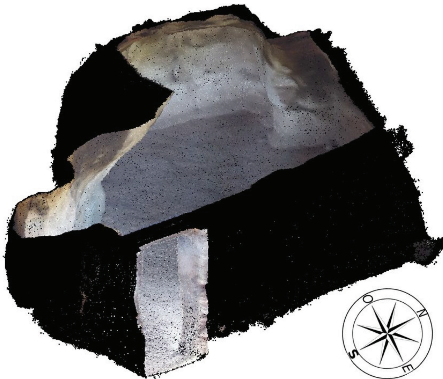
Figura 34. Vista isométrica de la cueva C del ERV obtenida mediante la nube de puntos del sistema LiDAR.
