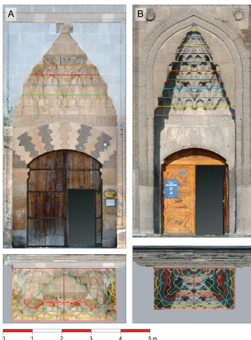
Figura 17. Planta y alzado de las capuchas de muqarnas. A: Puerta exterior del caravasar de Sari Han. B: Puerta exterior de la mezquita de Hunat Hatun. Con líneas de colores se indican ejes de simetría y las sucesivas bases de cada hilada de muqarnas (© Los autores).
