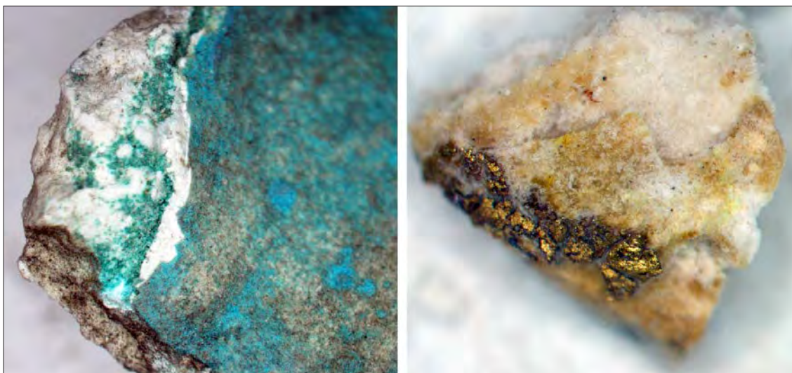
Fig. 10. Imágenes de microscopía óptica. Izqda: Imagen de la muestra. PD-Y-135 en la que se identifican capas sucesivas de color y un encalado entre las diversas capas. Dcha: Imagen de la muestra PD-Y-131 en la que se identifican restos metálicos de una capa dorada.
