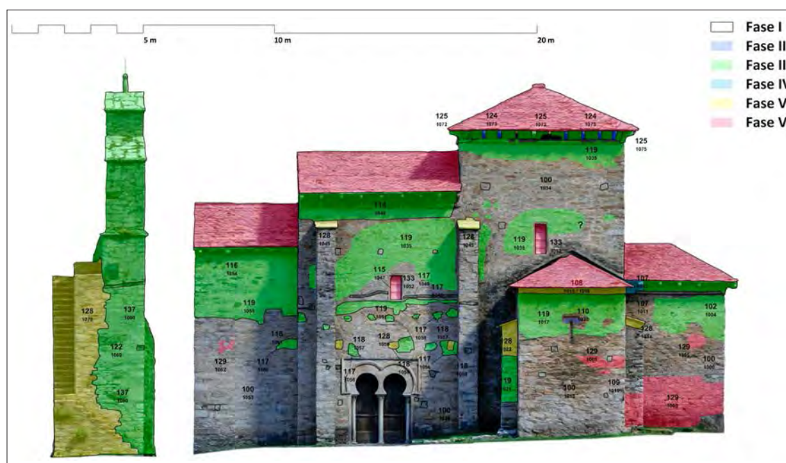
Fig. 2. Alzado sur de la iglesia de Santiago de Peñalba de Santiago con los resultados de su análisis estratigráfico
