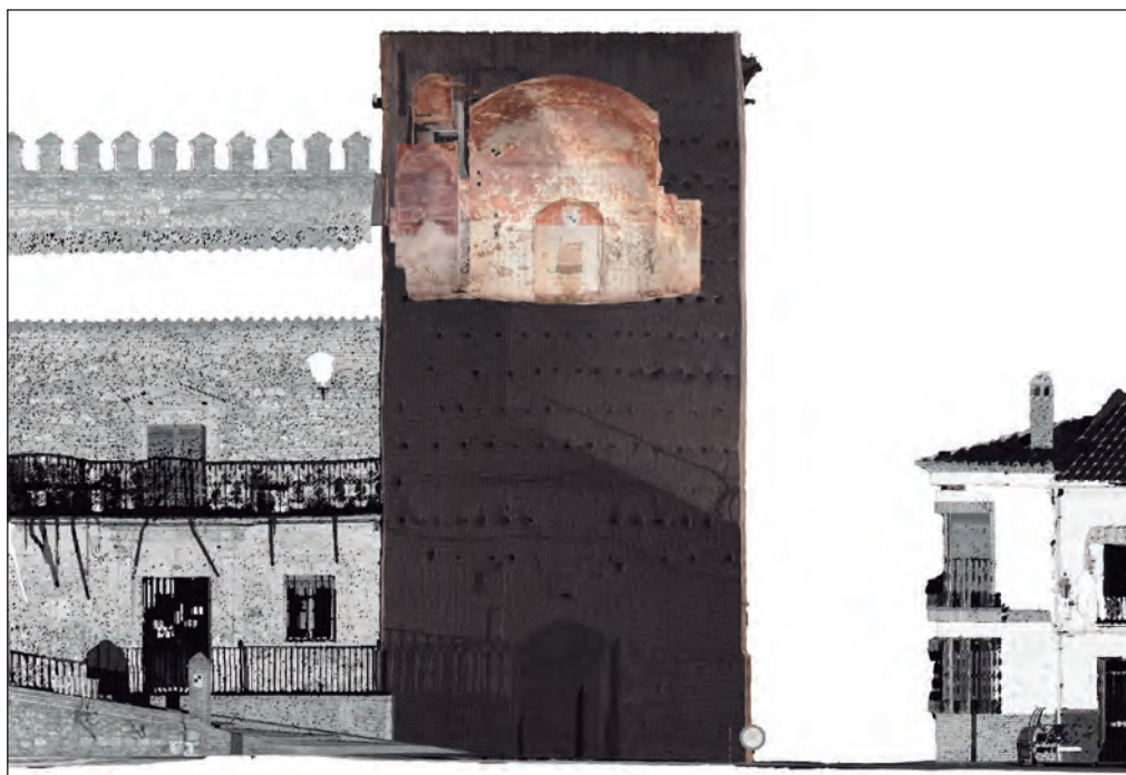
Fig. 6. Imagen con la sección proyectada de la cámara exterior sur de la torre estudiada. (Elaboración propia de los autores).
