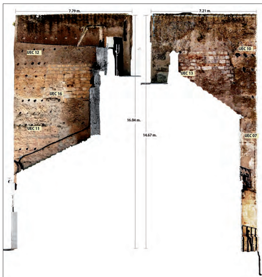
Fig. 4. Alzados de las fachadas norte y oeste de la torre sureste con identificación de sus unidades constructivas y sus medidas. (Elaboración propia de los autores).
