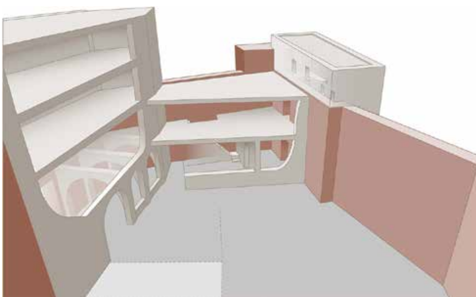
Fig. 13 Reconstrucción de los cuerpos oeste y norte adosados a la torre del Homenaje (Dibujo de M. Salvatierra)
