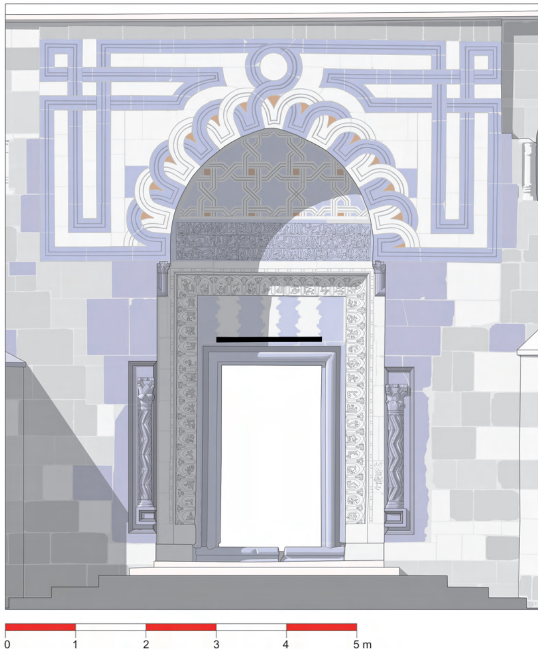
Figura 1. Alzado fotogramétrico de la portada norte de la mezquita 'Alā' al-Dīn, en Konya. Se ha suprimido la representación de la pieza que ciega la ranura sobre el dintel (© Los autores). Figura en alta resolución: https://revistaselectronicas.ujaen.es/index.php/ATM/article/view/8769/8868
