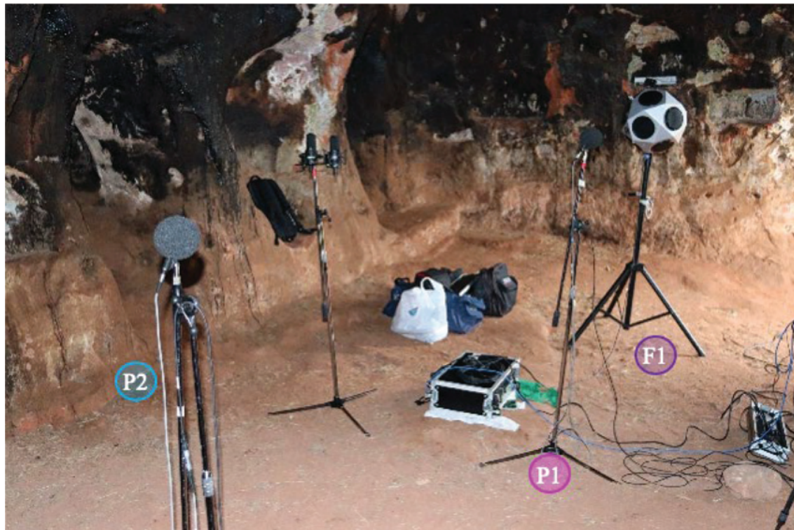
Figura 38. Vista con las ubicaciones de la fuente sonora (F1) y de las posiciones microfónicas P1 y P2, en la cueva central (A) del ermitorio rupestre de Valdecanales.
