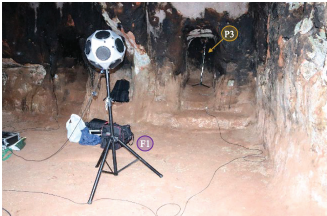
Figura 39. Relación posicional entre la fuente sonora F1 y posición de medida P3, en el interior de la cueva (A) del eremitorio rupestre de Valdecañales.
