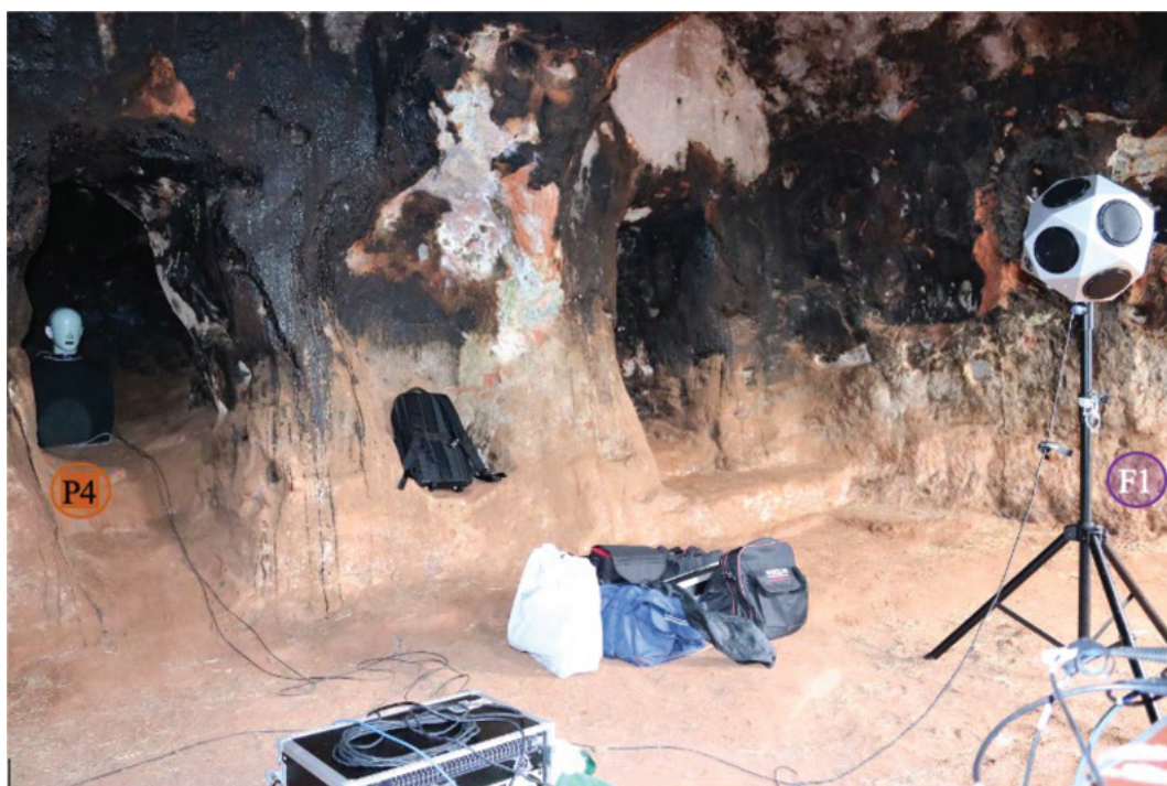
Figura 40. Relación posicional entre la fuente sonora F1 y posición de medida P4, en el interior de la cueva (A) del eremitorio rupestre de Valdecañales.
