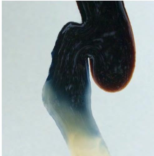
Figura 2. Reacción entre el sulfato de hierro y el infundado de agallas de roble dando lugar a la tinta metálica medieval.
