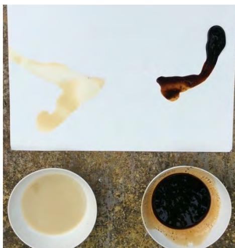
Figura 4. Disolución férrica (izquierda) e infusión gálica (derecha), con aplicación sobre papel de mesa docente.
