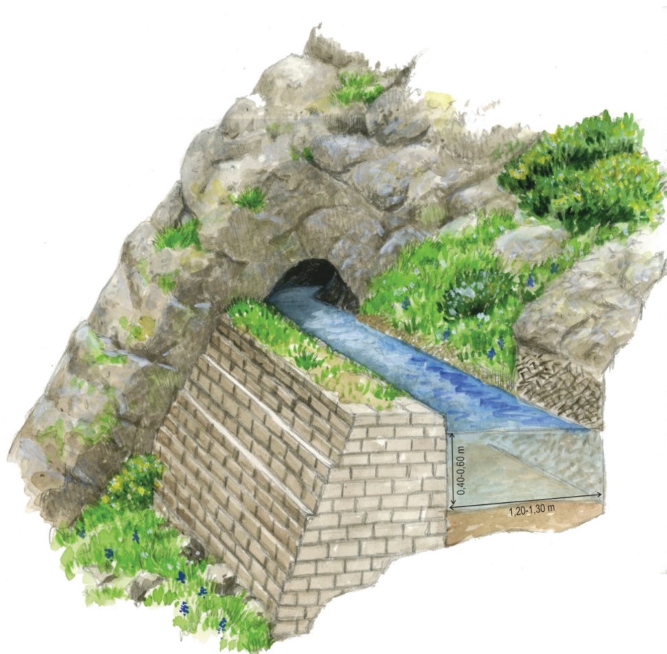
Figura 8. Reconstrucción gráfica del paso de un crestón de cuarcita en el canal C-1 de Las Médulas en Santalavilla-León
