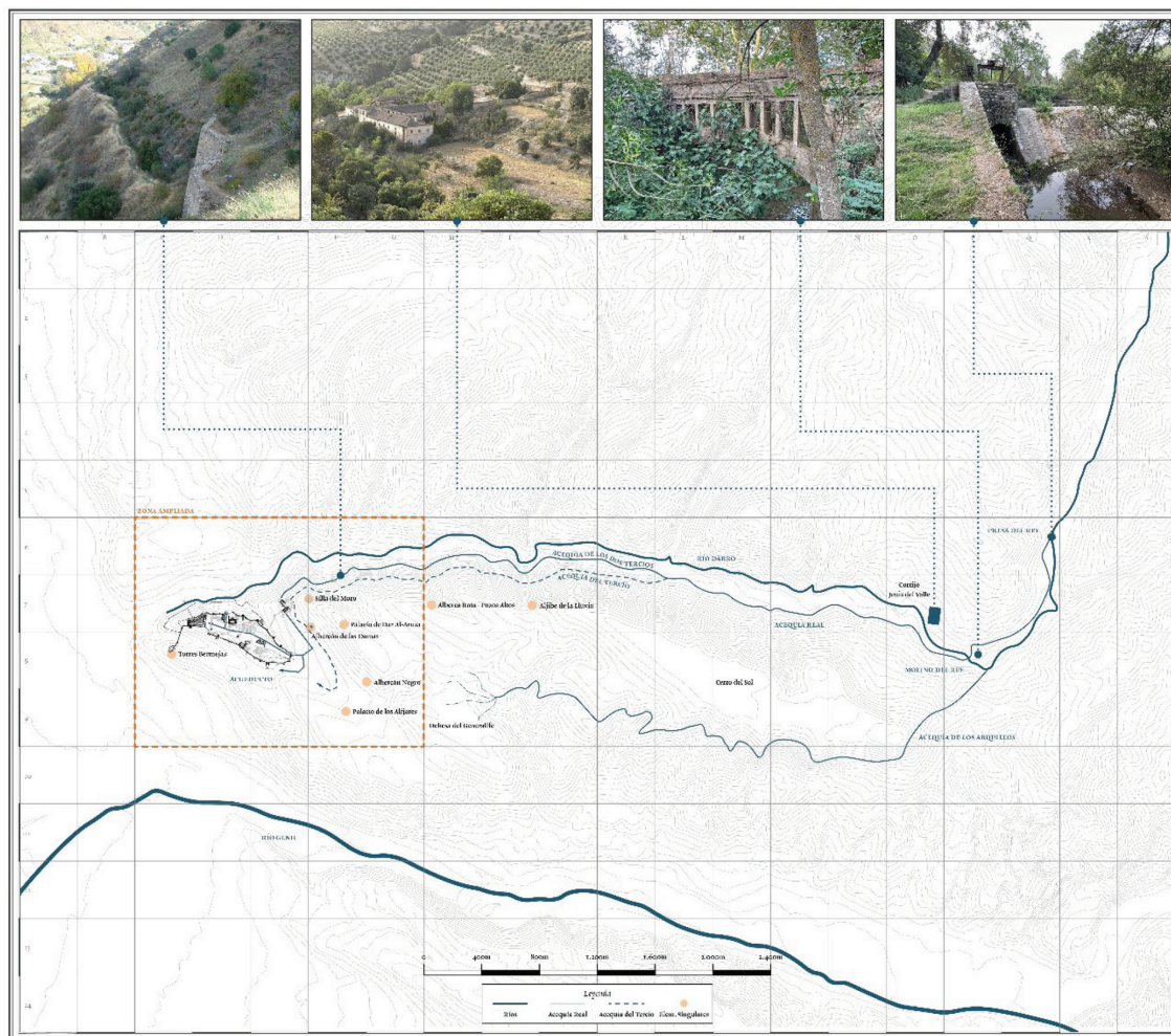
Figura 3. Plano de acequias en época nazarí, con la localización de distintos hitos e ingenios hidráulicos, ilustrados arriba con fotografías y referenciados en el mapa, según su localización (la zona recuadrada se amplía en la siguiente figura). Las fotografías documentan el estado actual de elementos citados en el texto, de derecha a izquierda: la presa del Rey, el canal elevado del cortijo Molino del Rey, el cortijo de Jesús del Valle, la acequia Real y la acequia del Tercio.
