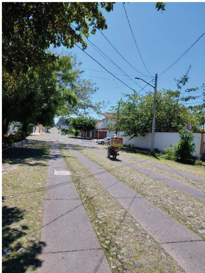
Figura 1. Pavimento con huella de rodamiento
