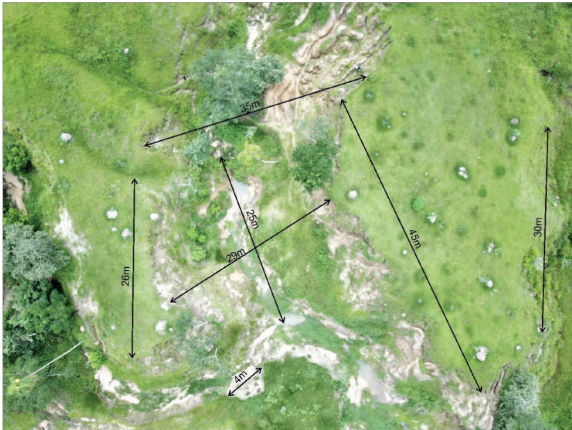
Figura 2. Dimensões aproximadas de alguns setores do sistema erosivo analisado obtidas via Google Earth Pro
