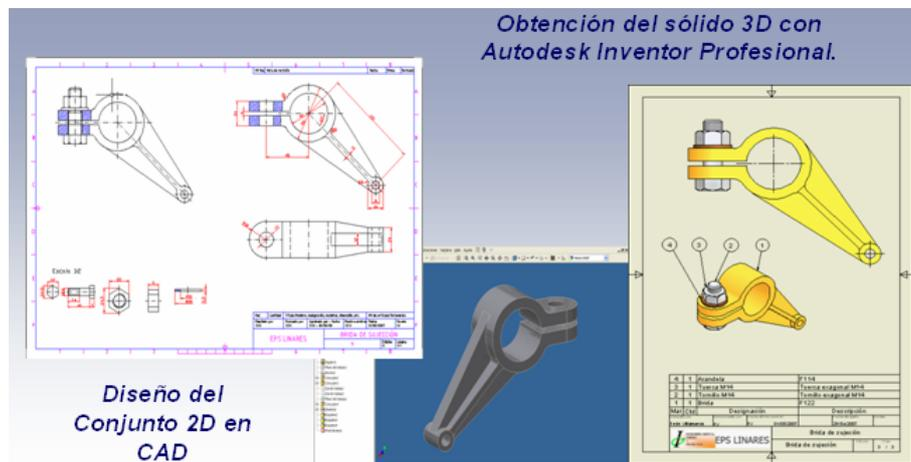
**Figura 1.** Obtención del modelo sólido en 3D.
